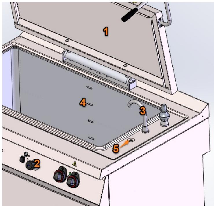
Bevor Sie mit dem Kochen beginnen, müssen Sie zunächst den Wasserstand im Verdoppler überprüfen, indem Sie den Überlaufhahn öffnen. Wenn kein Wasser aus dem Verdoppler kommt, muss das Wasser durch Halten des Wippschalters abgelassen werden. Wenn das Wasser zu fließen beginnt, schließen Sie den Überlaufhahn. Hinweis: Bei AWF-Versionen kann dieser Schritt übersprungen werden.
